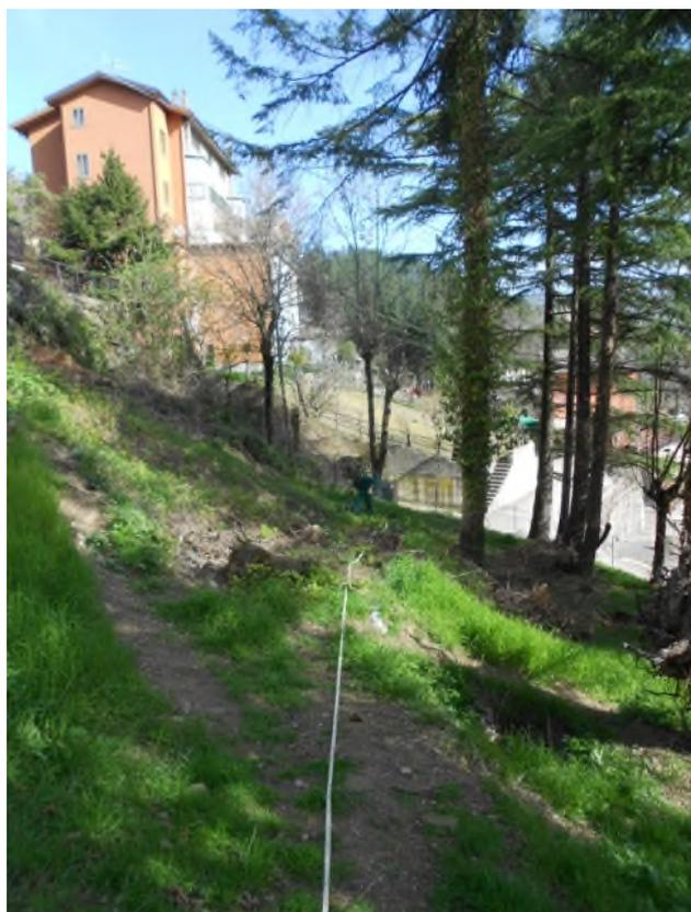
Figura 81 – a SX PIAZZAMENTO MASW MW\_B8
